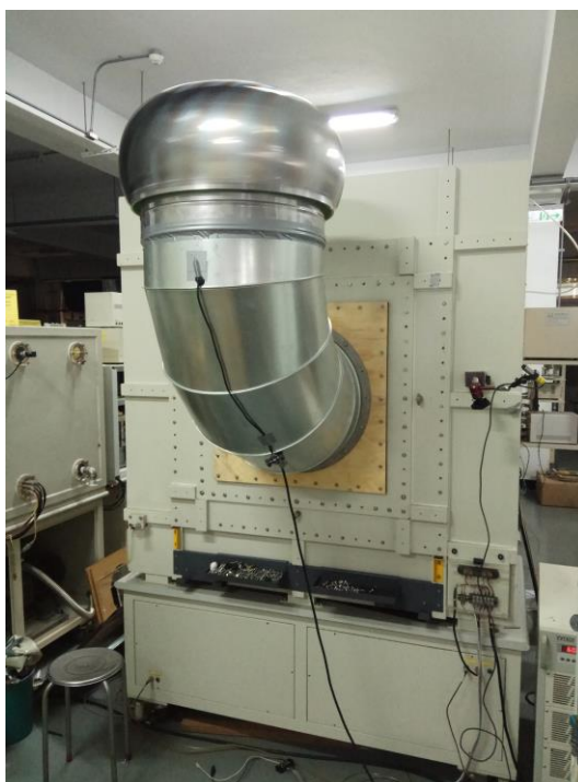
圖 1.2：PF-500R 風電兩用型排風機(球)風洞測試照片
